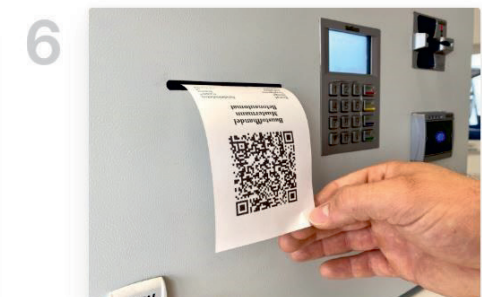
QR-Code erhalten, an SB-Terminal der Anlage scannen und die Produktion starten
